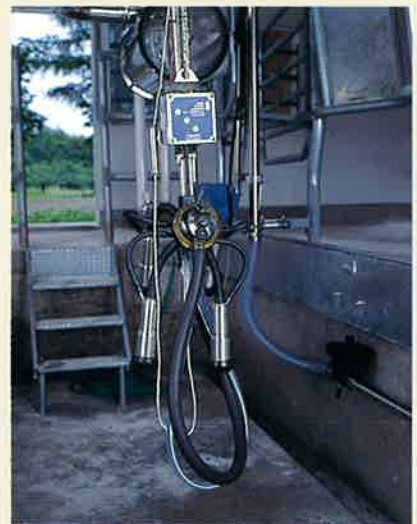
ワイカト・ディタッチャー ●スイングパーラー専用自動離脱装置。
