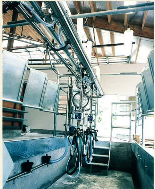
4インチ（101mm）ステンレス製ミルクライン、3インチ（75mm）ステンレス製パルセーションライン。電磁パルセータの採用により、ミドルラインスイングパーラーで最高の搾乳を提供します。
