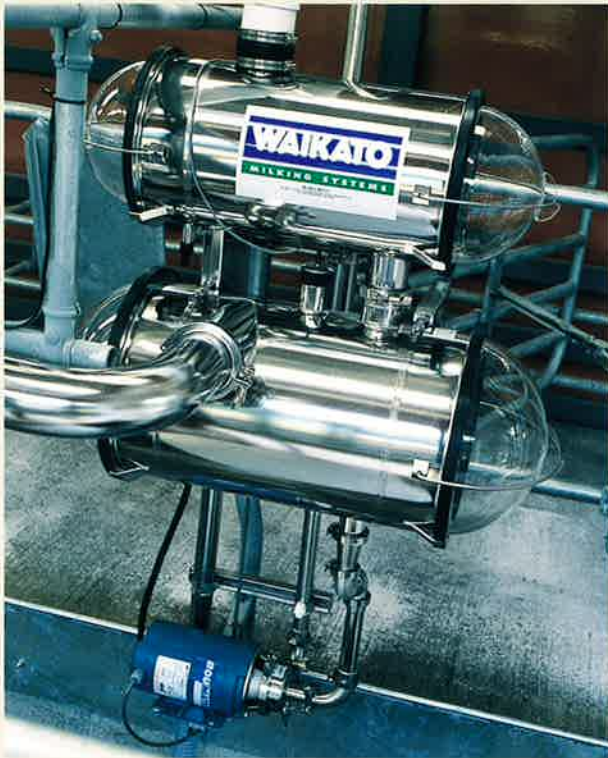
大容量（60リットル）ステンレス製レシーバージャーとステンレス製モイスタートラップ。
